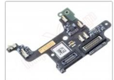
Placa auxiliar de contactos de antena OnePlus 5, A5000
