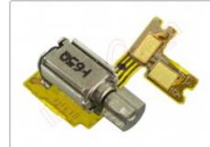
Vibrador Huawei P9 Lite
