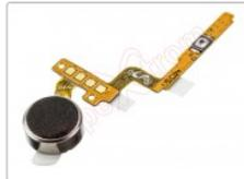
Flex con botón de encendido y vibrador para Samsung Galaxy Note 4, N910F
