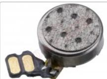
Vibrador genérico de 10,4 x 7,95 x 3,18 mm
