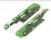
Placa auxiliar con conector micro usb de carga, datos y accesorios para
