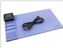
Tapete térmico de apertura mediante calor, CPB320
