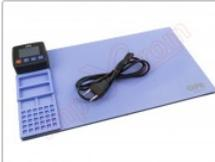
Tapete térmico de apertura mediante calor, CPB320
